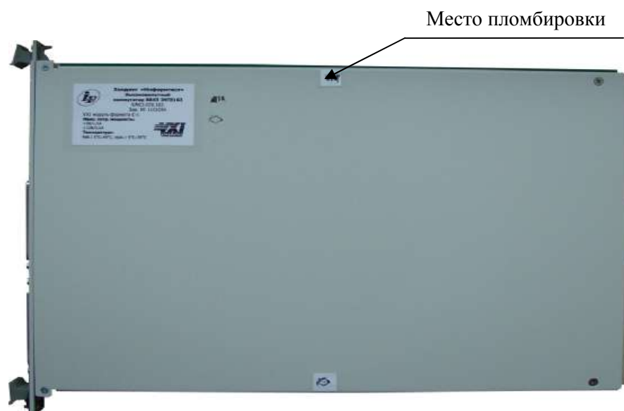
Рисунок 2 – Пломбировка модуля-носителя с установленными на него функциональными мезонинными модулями
