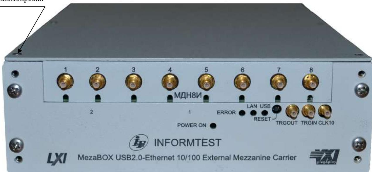
Рисунок 4 – Внешний вид устройства MezaBox ФТКС.469133.006 с установленным измерителем МДН8И
