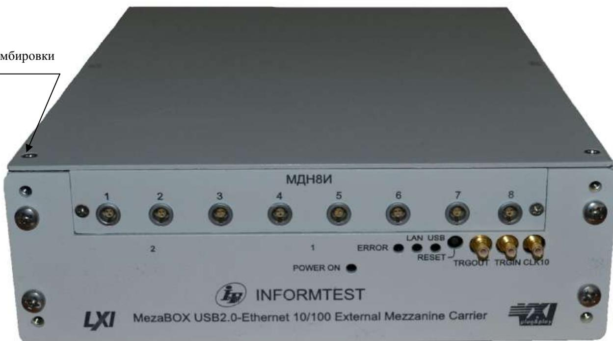
Рисунок 3 – Внешний вид устройства MezaBox ФТКС.469133.006 с установленным измерителем МДН8И-01
