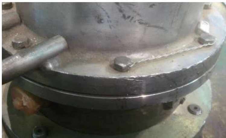
Рисунок 2 – Пломбировка датчика от несанкционированного доступа
