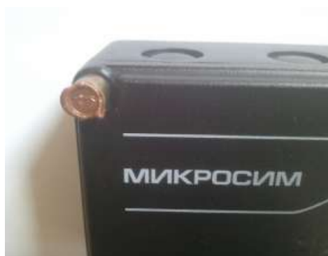
Рисунок 3 – Пломбировка преобразователя от несанкционированного доступа
