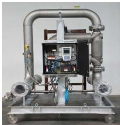
Рисунок 1 – Общий вид установок поверочных мобильных эстакады автоматизированного тактового налива нефтепродуктов СВРm
