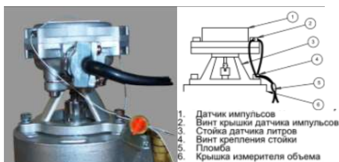
Рисунок 4 – Пломбировка датчика импульсов ДИФВ-2
