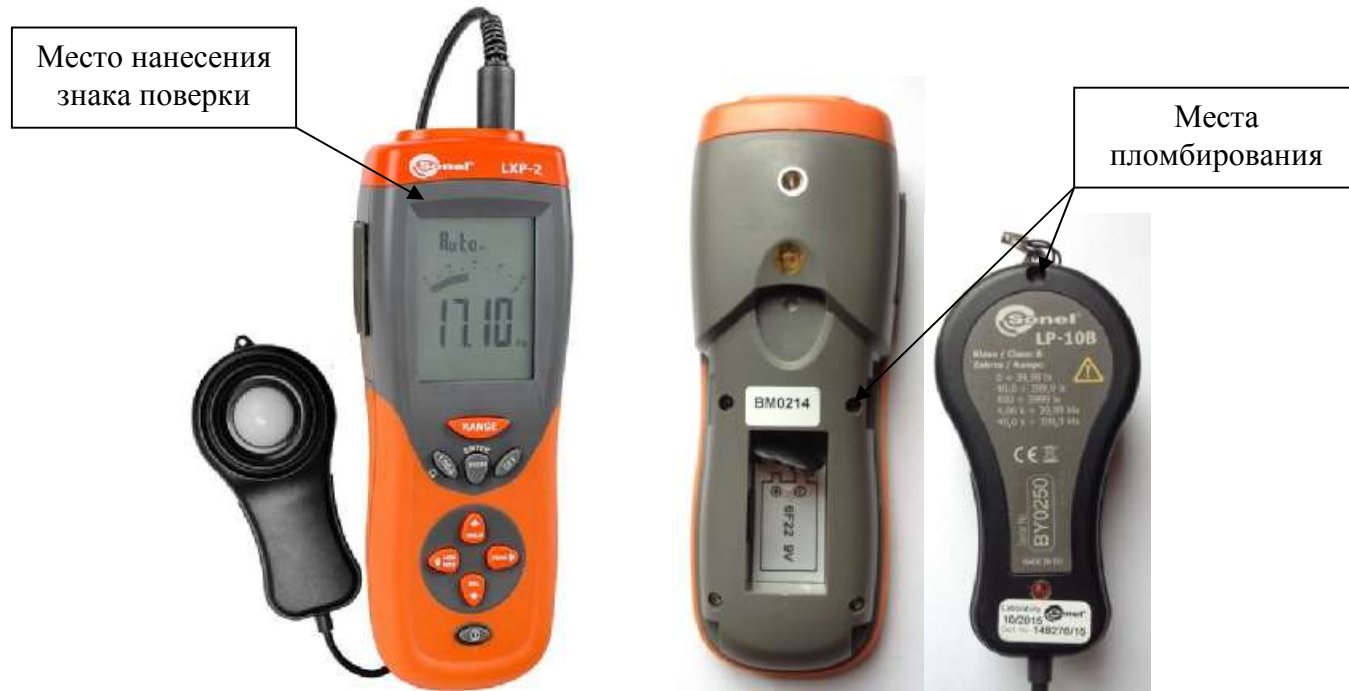
Рисунок 1 - Общий вид люксметров LXP-2 и LXP-10B с указанием мест пломбирования и нанесения знака поверки
