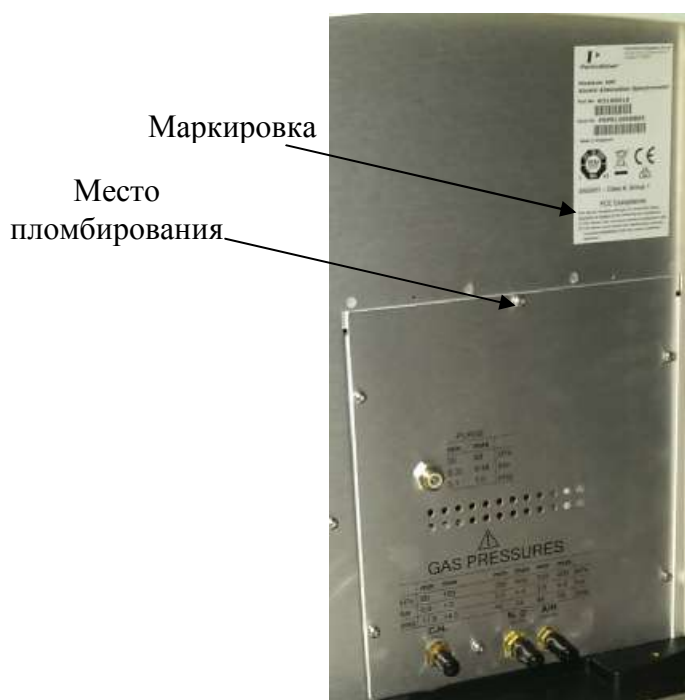
Рисунок 2 - Задняя панель спектрометра атомно-абсорбционного PinAAcle 500
