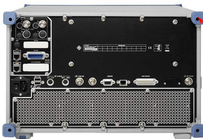
Рисунок 6 - Задняя панель векторного анализатора электрических цепей ZVA 24
