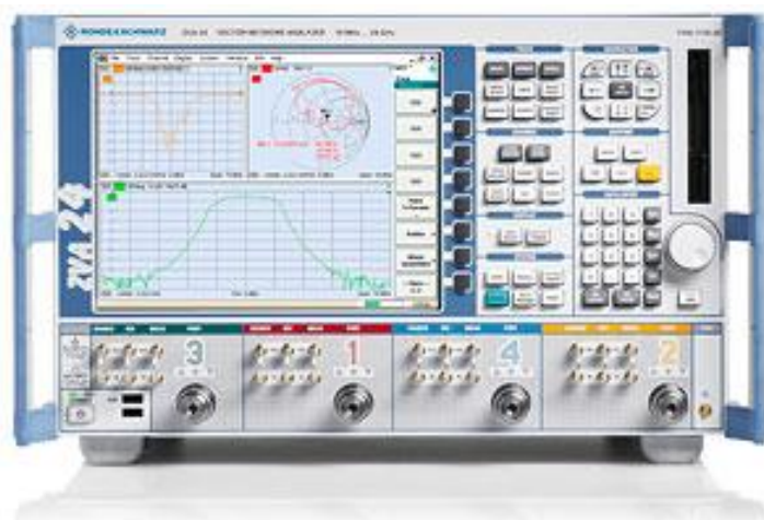
Рисунок 5 - Внешний вид векторного анализатора электрических цепей ZVA 24
