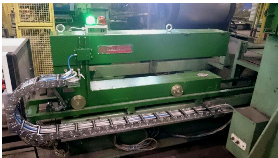
Рисунок 1 - Общий вид системы измерений толщины ИТ-3А-7К
