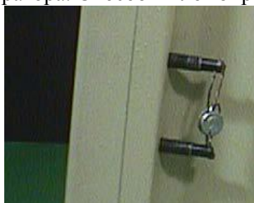
Рисунок 3 - Способ пломбировки контроллеров AccuLoad III
