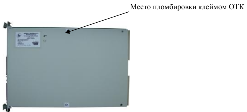
Рисунок 2 – Пломбировка функционального модуля
