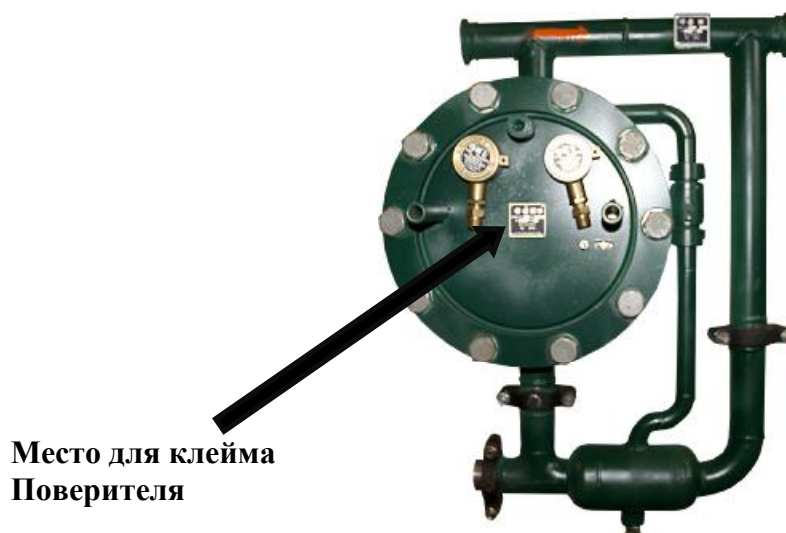
Рис.1. Общий вид первичного преобразователя расхода СКЖ-СН
