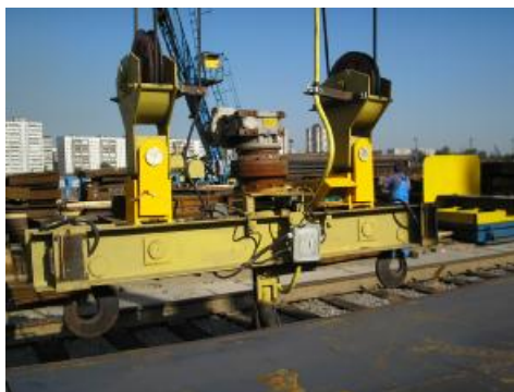
Рисунок 1 – Внешний вид весов ВКТ-20 (слева) и ВКТ-25 (справа).
