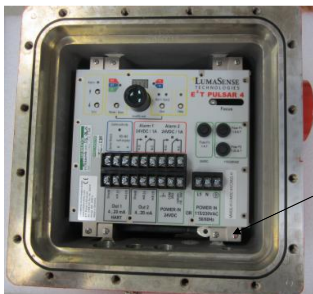
Рисунок 2 - Вид пирометров инфракрасных серии 3909020 E 2 T Pulsar 4 и серии 3909010 E 2 T Pulsar 4 модернизированные при открытом взрывозащитном корпусе с указанием места пломбирования
