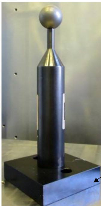
Рисунок 3 - Общий вид сферы с антибликовым покрытием
