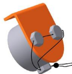
Рис.2 - Схема пломбировки окна ИК-датчика
