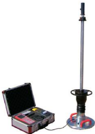
Рисунок 1 - Измеритель динамического модуля упругости грунтов серии LFG
