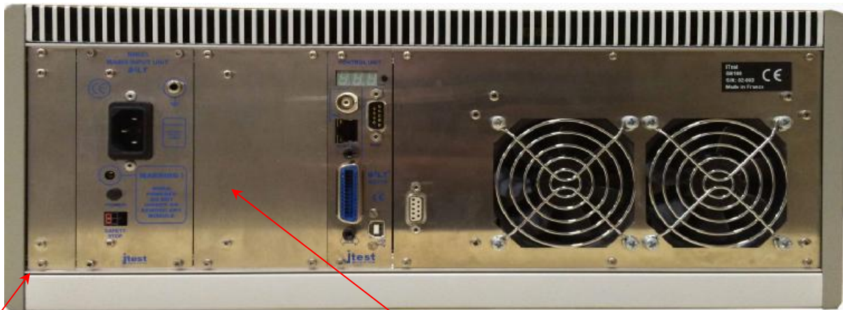
место пломбирования (защитный стикер) место нанесения знака утверждения типа и знака поверки
