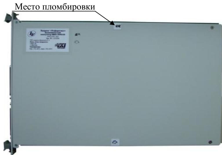
Рисунок 4 – Схема пломбировки функциональных модулей
