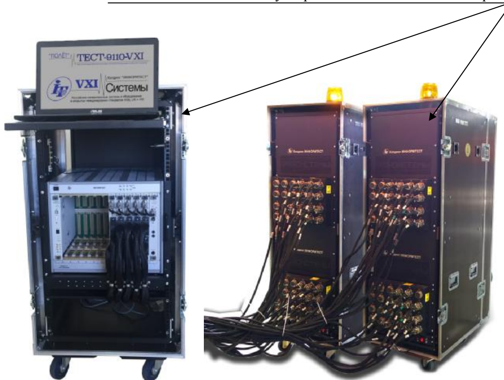
Рисунок 3 – Внешний вид систем на основе стандарта VXI, включающих до 4600 каналов (слева) и более 4600 каналов (справа)
