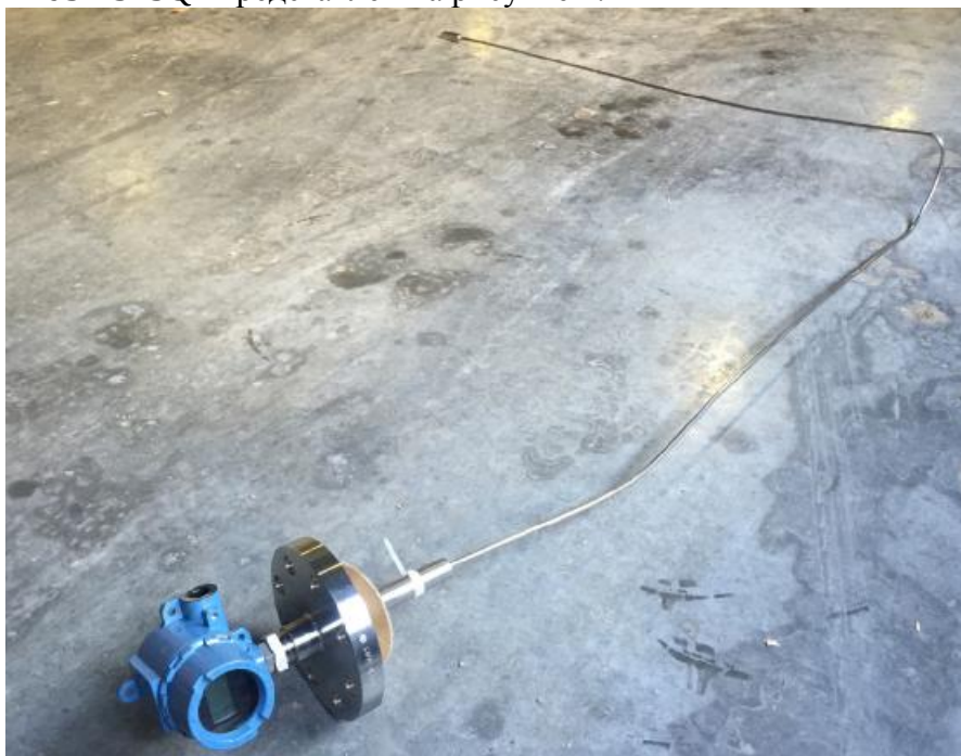
Рисунок 1 – Общий вид преобразователя термоэлектрического с унифицированным выходным сигналом FPN/644HAI1J5M5F5Q4
