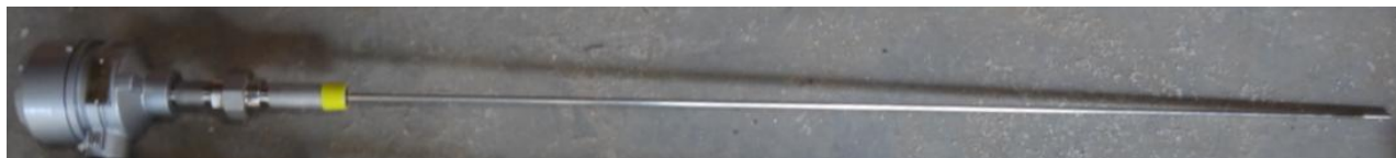
Рисунок 1 – Общий вид преобразователя термоэлектрического с унифицированным выходным сигналом OFP/644HANA5Q4
