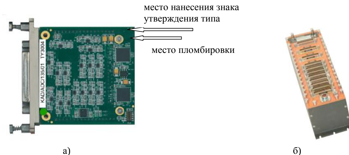
Рисунок 1 - Внешний вид модуля КАД/АДС/135 (а) и модуля КАД/АДС/135 установленного в блок базовый КАМ/СНС/13U (б)
