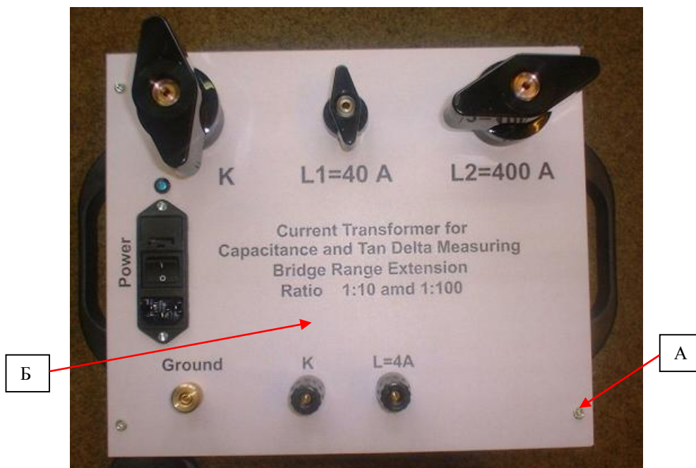
Рисунок 1 – Общий вид трансформатора тока СТ-2FRO Место пломбировки от несанкционированного доступа (А) и нанесения знака поверки (Б)
