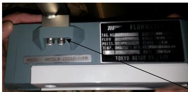
Рисунок 2 - Обозначение места пломбировки ротаметров AM91LW
