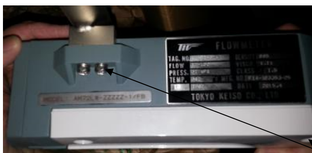
Рисунок 2 - Обозначение места пломбировки ротаметров М-901
