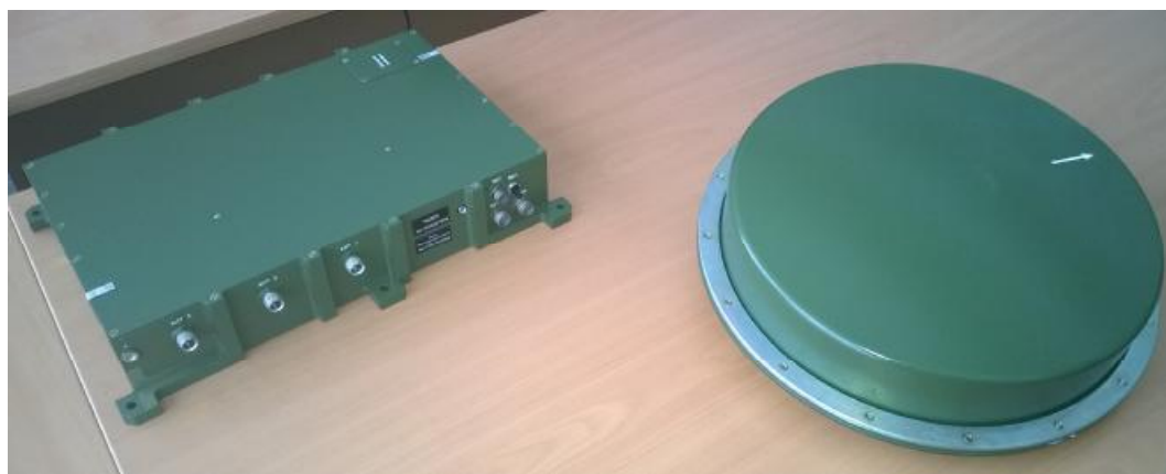
Рисунок 1 - Внешний вид аппаратуры (слева - блок приемовычислителя, справа - блок антенный БА41)
