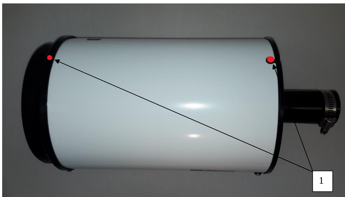
Рисунок 2 - Схема пломбирования осадкомеров МПДО-500 1 - пломбы на корпусе.
