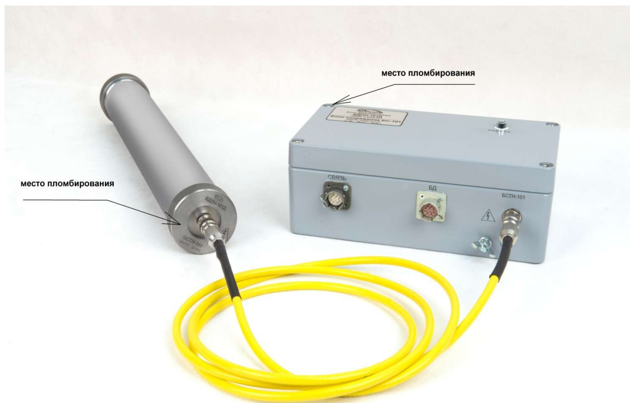
Рисунок 1 - Общий вид блока детектирования БДПН-101Д
