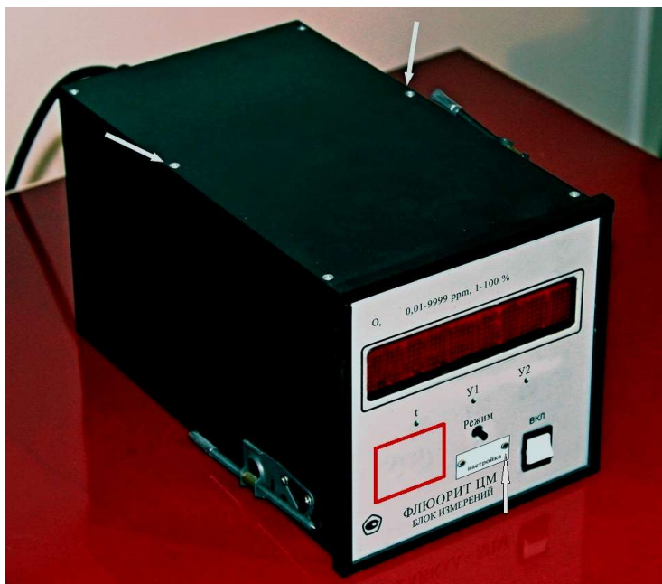
Рисунок 3 - Блок измерения ИСП2. Схема пломбировки от несанкционированного доступа. Места для пломбирования обозначены стрелками. Прямоугольником обозначено место нанесения знака утверждения типа и знака поверки.
