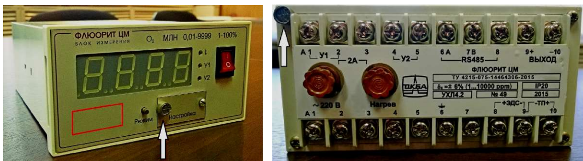
Рисунок 1 - Блок измерения ИСП1. Схема пломбировки от несанкционированного доступа.
