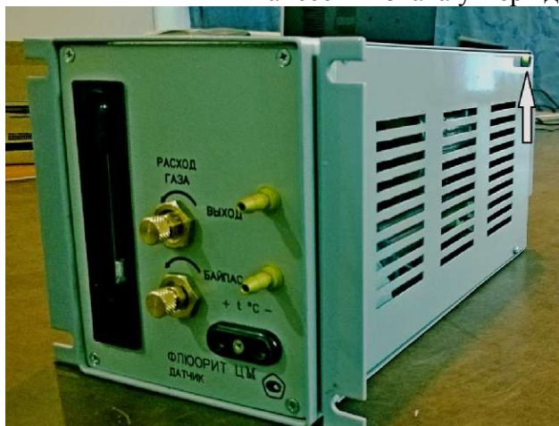
Рисунок 2 - Датчик. Схема пломбировки от несанкционированного доступа. Места для пломбирования обозначены стрелками.
