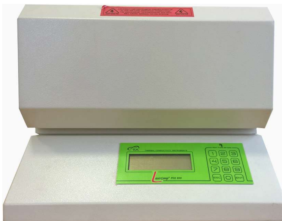
Рисунок 1- Общий вид измерителя теплопроводности FOX 200
