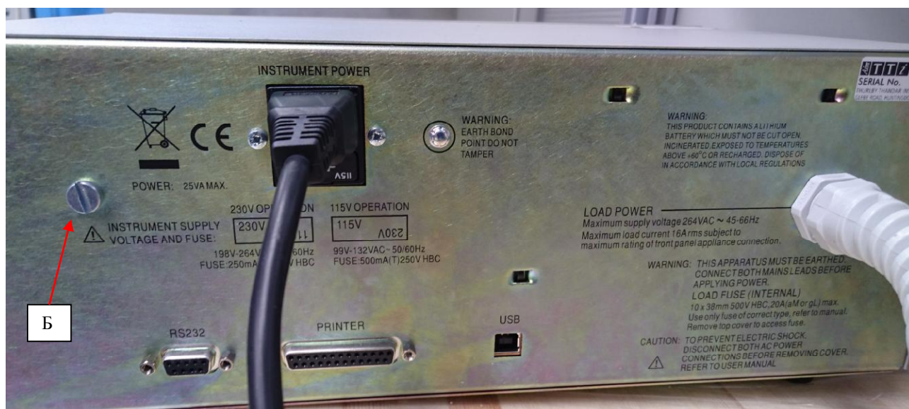
Рисунок 2 - Место пломбировки от несанкционированного доступа (Б)
