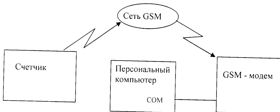
Рисунок А.5 – Схема подключения счётчиков к компьютеру через GSM модем
