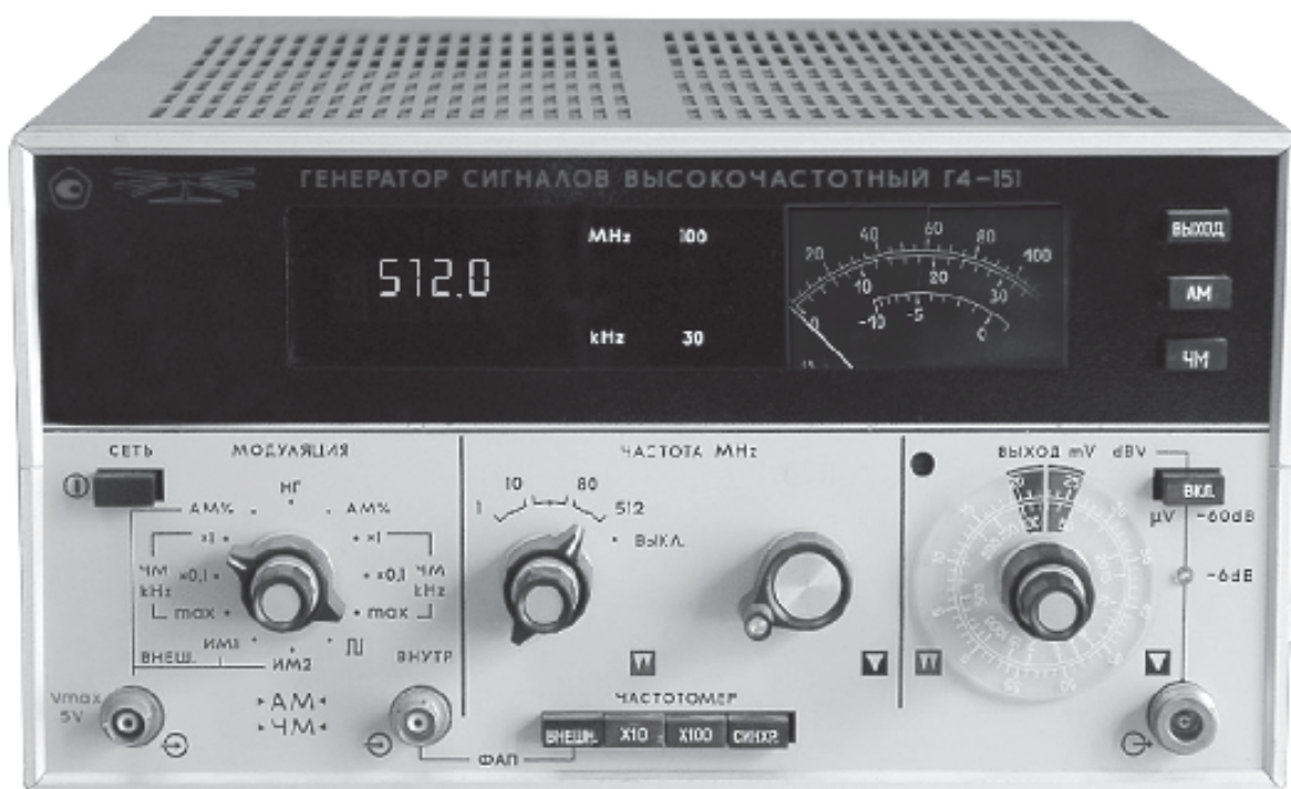
Рисунок 1 - Общий вид генератора сигналов высокочастотного Г4-151
