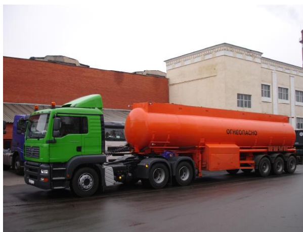
Рисунок 3 - Общий вид полуприцепов-топливозаправщиков БЦМ-42.2 модель 96052-02
