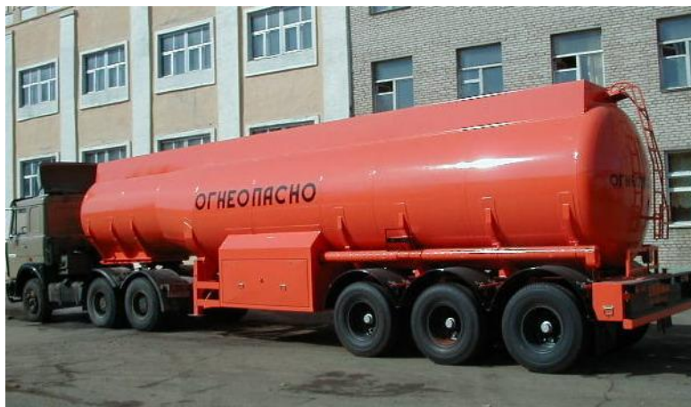
Рисунок 1 - Общий вид полуприцепов-топливозаправщиков БЦМ-42 модель 96052
