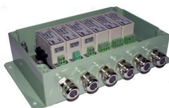
Рисунок 5 - Многоканальное устройство сопряжения УСО ПИК-V (VT)
