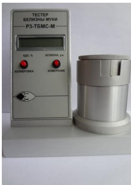
Рисунок 1 – Тестер белизны муки РЗ-ТБМС-М
