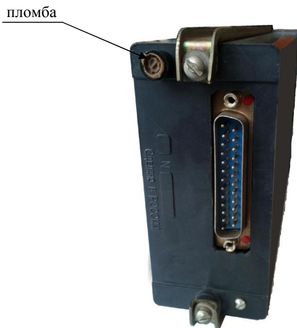
Рисунок 7 - Схема пломбировки от несанкционированного доступа Задняя стенка с разъемом и пломбой
