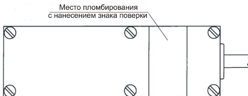
Рисунок 9 - Схема пломбировки от несанкционированного доступа, обозначение мест нанесения знака поверки преобразователя ваттметров М3-104, М3-105, М3-106
