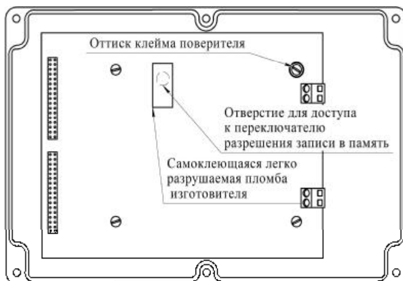
Рисунок 4 – Места пломбирования измерительной платы шестиканального вычислителя.
