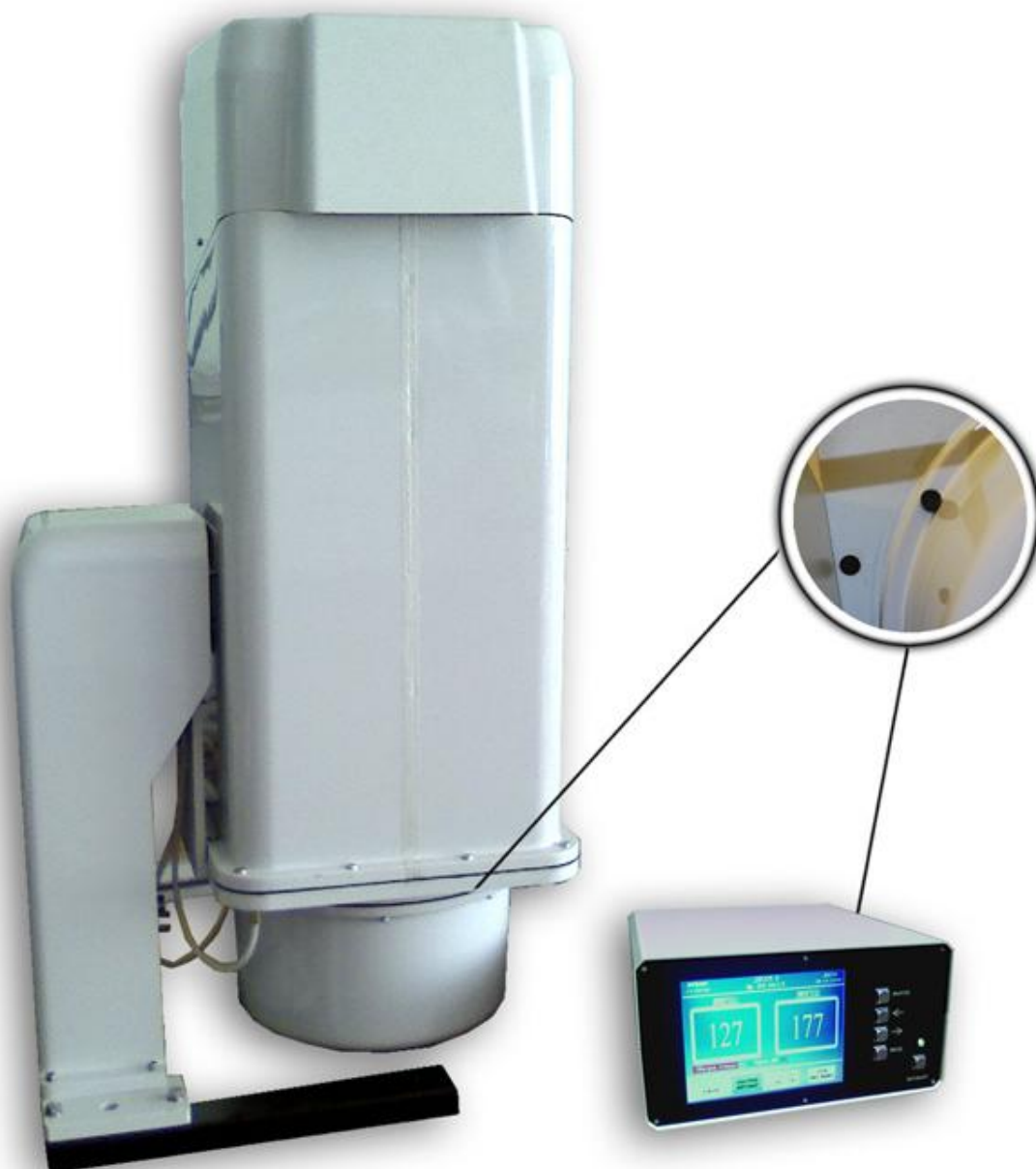
Рисунок 1. Общий вид и места пломбирования датчика облаков лазерного ДОЛ-2
