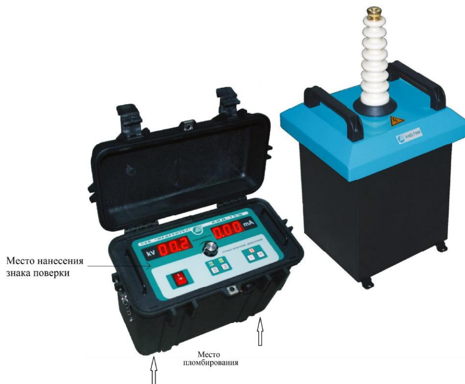
Рисунок 1 - Общий вид аппаратов испытания диэлектриков «АИД-70М» (модификация 1)
