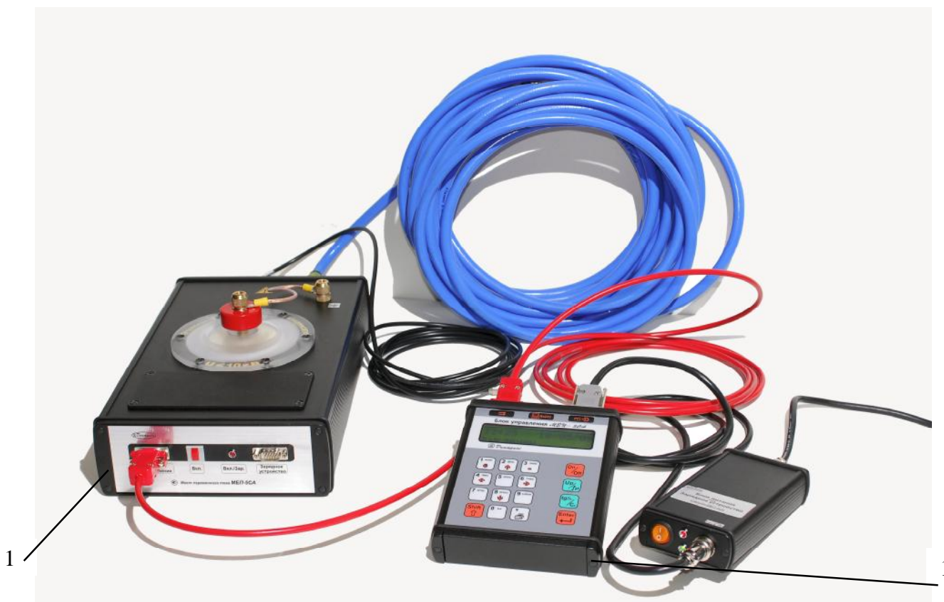
Рисунок 1 – Внешний вид и схема пломбирования от несанкционированного доступа (1 – Место для нанесения оттиска клеем)
