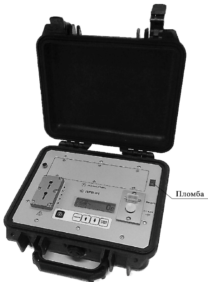
Рисунок 1 - Внешний вид и схема пломбировки приборов от несанкционированного доступа
