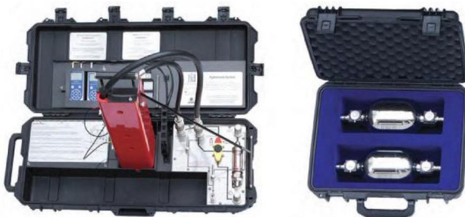
Рисунок 1 - Общий вид установки и комплекта напорных пикнометров
