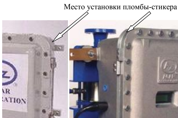
Рисунок 3 – Место пломбирования влагомеров нефти AGAR OW
