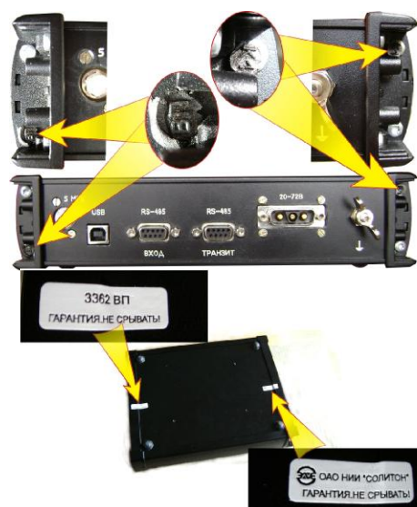
Рисунок 2 - схема защиты СИ от несанкционированного доступа
