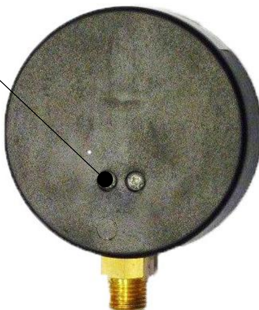
Фото 6 - Место пломбирования термоманометров F+R828, TIRM-ABS
