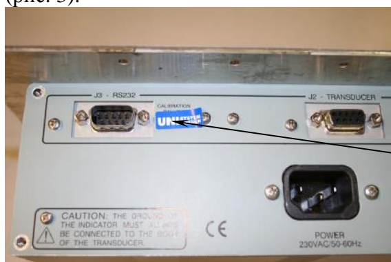
Рисунок 1 – Пломбировка выключателя режима юстировки
