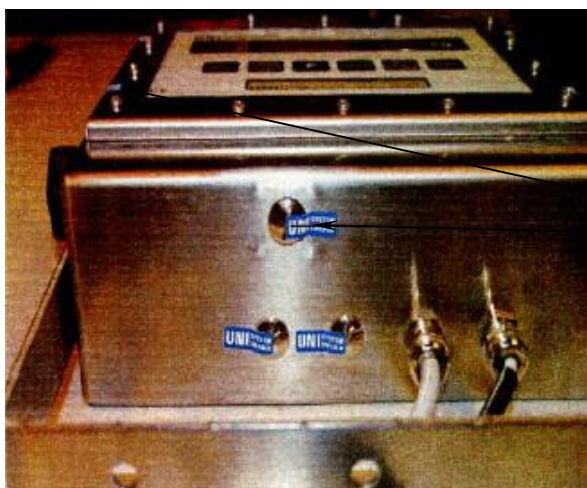
Рисунок 2 – Пломбировка корпуса индикатора.
