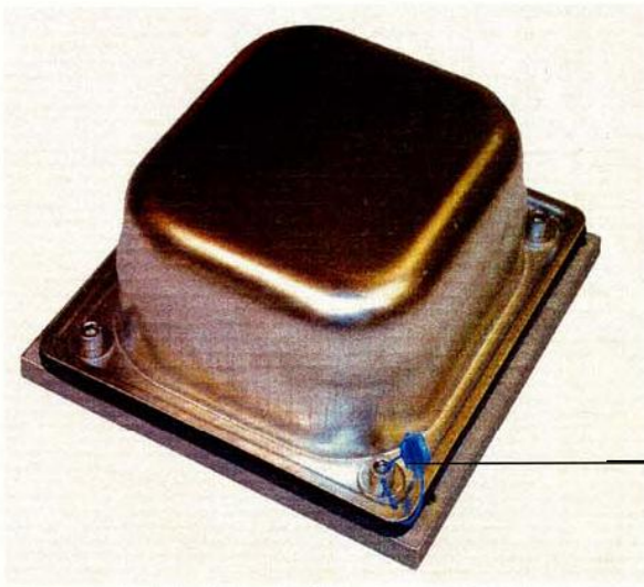
Рисунок 3 – Пломбировка блока компенсации качки и влияния изменения гравитации.
