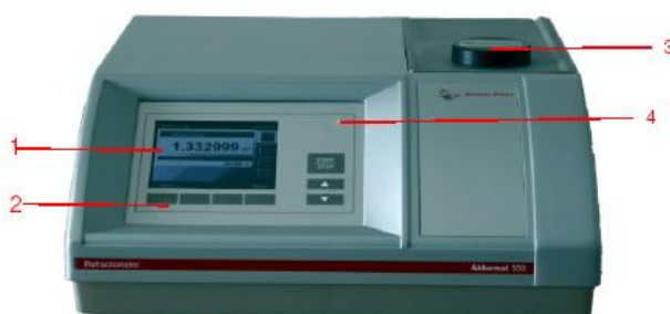
1 – цветной жидкокристаллический дисплей; 2 – мембранная клавиатура; 3 – съемная крышка отсека для измеряемого образца, 4 – индикатор включения
