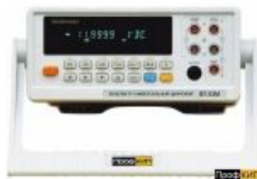
Рисунок 1 - Фотография общего вида вольтметров универсальных В7-64М
